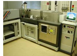
Abb. 1. Fluorlaser Workstation bestehend aus Laser, Strahlengang, Bearbeitungskammer und Steuereinheit
