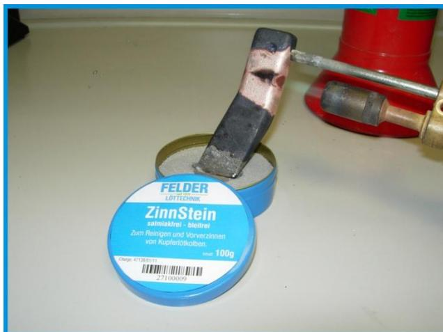
Der Stein ist im kalten Zustand fest. Da er jedoch aus einer Mischung mit Metallpulver besteht, wird er beim Kontakt mit dem heißen LötKolben flüssig. Allein durch das Eintauchen in den zinnhaltigen Stein kann der Kolben in nur einem Schritt gereinigt und verzinkt werden. Die Arbeit erledigt sich quasi automatisch. Insbesondere Dachdeckern erspart diese Entwicklung Zeit und Aufwand.
