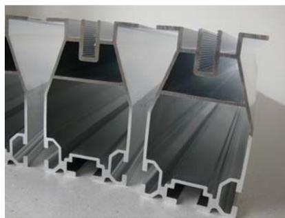
Das KLEMENS XL-Tragprofil: Oben der Gewindekanal, an der Seite die Nuten und unten die Kombi Nut.
