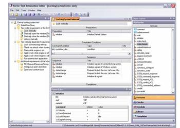
Stuttgart, 21.12.2007 – Testabläufe zum Überprüfen der korrekten Applikationsfunktion und der Netzwerkkommunikation lassen sich mit dem neuen Test Automation Editor einfach und schnell erstellen sowie parametrieren. Dabei profitieren Steuergeräte-Entwickler, Testingenieure und Fachexperten durch eine intuitive Visualisierung und Bearbeitung der Testfälle aus CANoe XML Testmodulen. Der Test Automation Editor eignet sich für den Einsatz in allen Testphasen des Entwicklungsprozesses.
