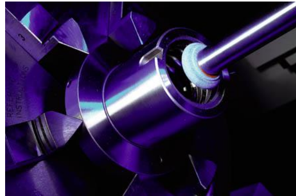
Bild Nr. 03-04 TT_Innengew.jpg Bauteile mit einem Durchmesser von 15 bis 150 Millimeter und einer Länge bis 150 Millimeter können in Serie bearbeitet werden.
