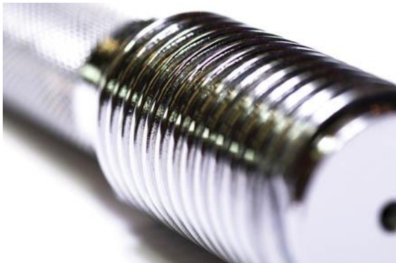
Bild Nr. 03-03 TT_Aussengew2.jpg Beide Präzisionsmaschinen sind ausgelegt auf das Gewindeschleifen bei Kleinteilen.
