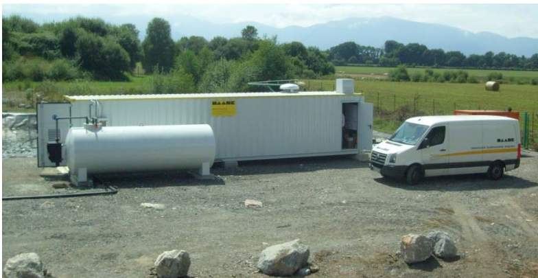
Bild: Mobile HAASE UO-Containeranlage im Einsatz auf Deponie in Frankreich
