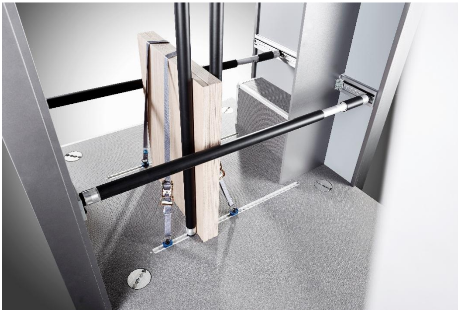
Abbildung 1 VANYCARE®-Komplettausstattung incl. Ladungssicherungssystem mit Sperrstange, Zurrschienen und Gurten
