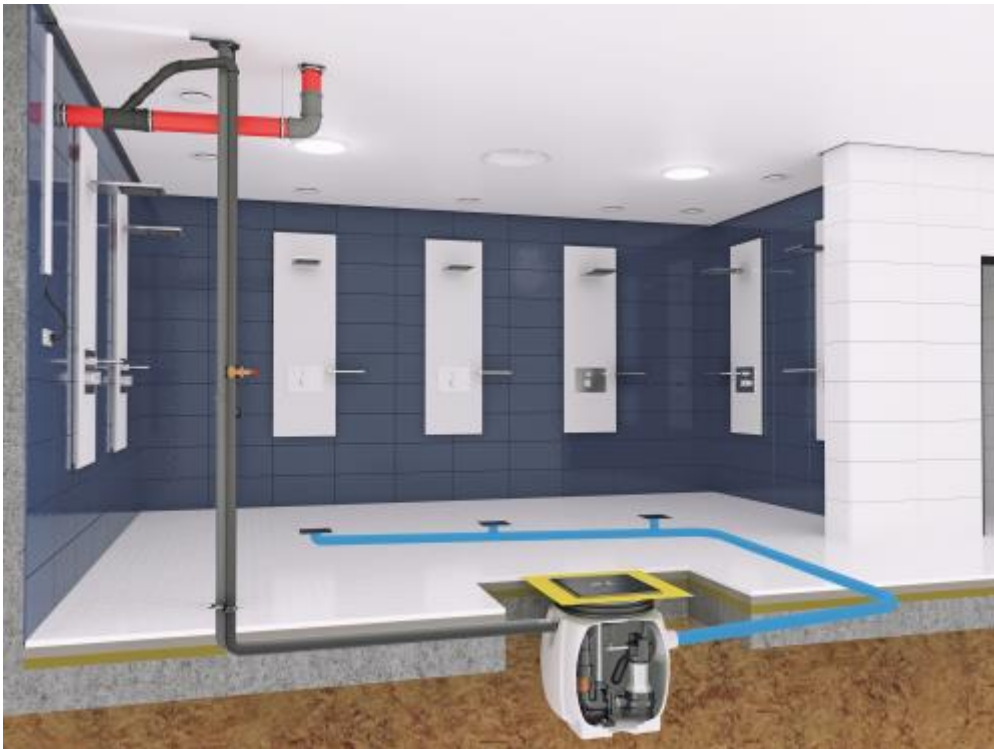
Abb. 3: Einbaubeispiel Baufix 200 für die Schmutzwasserentsorgung eines öffentlichen Duschbereichs
