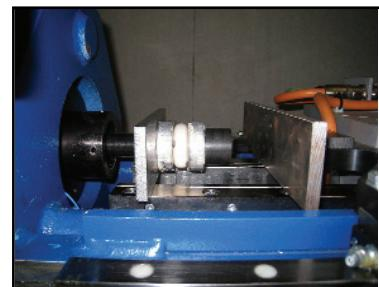
Wie hoch Energieaufnahme und -absorbierung der TUBUS-Spezial Niederhalterdämpfer sind, wurde in Testreihen auf Prüfständen bei ACE ermittelt
