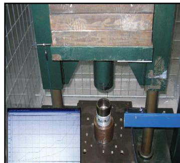
Dynamische und quasi statische Kraft-Wegkennlinien wurden in Tests aufgezeichnet und mit Vorgängerlösungen verglichen. Sie sind in Normblätter vieler Kfz-Hersteller aufgenommen und zeigen im Vergleich zu früher höhere maximale Kraftwerte
