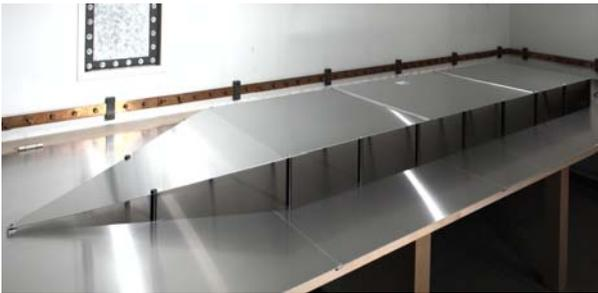
Mit der 50Ω - Streifenleitung (Stripline) können Auswirkungen sowohl der Aussendungen als auch Beeinflussungen durch elektromagnetische Felder bis 1 GHz auf Kfz-Komponenten geprüft werden. Bei der Bestrahlung werden dabei bis zu 400 V/m erreicht (Septumlänge 1,50 m). Somit können alle Anforderungen an die Störfestigkeit und -emission der verschiedenen Kfz-Hersteller berücksichtigt werden.
