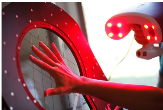
Portabler 3D Scanner erlaubt präzise und schnelle Erfassung dreidimensionaler Formen. ©Hohenstein
