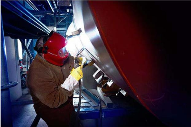
**Abb 1.:** pipeSolution® steht für schnelles und absolut sicheres MAG-Wurzelschweißen – beim Fügen von Hand oder automatisiert. Voith Industrial Services nutzt die Vorzüge dieses neuen Schweißprozesses bereits für seinen Rohrleitungsbau
