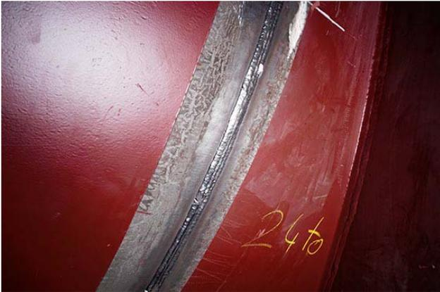
**Abb 5.:** Perfektes MAG-Schweißen in einem Arbeitsgang – der programmgesteuerte energiereduzierte pipeSolution®-Prozess sorgt in jeder Schweißposition für die gewünschte Schmelzbad-Viskosität
