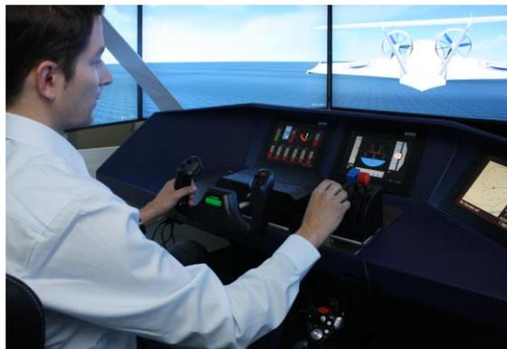
Bild: Bodeneffektfahrzeuge, ein Mix aus Schiff und Flugzeug, sind aufgrund ihrer Besonderheiten sowie der hohen Geschwindigkeiten auch für erfahrene Kapitäne ohne Training kaum steuerbar. Als wesentlichen Beitrag für die praxisnahe Schulung der Fahrzeugführer entwickelte das Fraunhofer IGD mit seinen Partnern den ersten BEF-Trainingssimulator Europas. (Nutzungsrechte Fraunhofer IGD)
