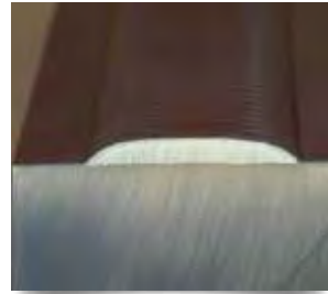
Laser – geringe Aufmischung
