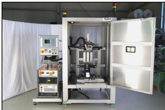
Laserbeschriftungsanlage aus item Profilen des MB Systembaukastens
