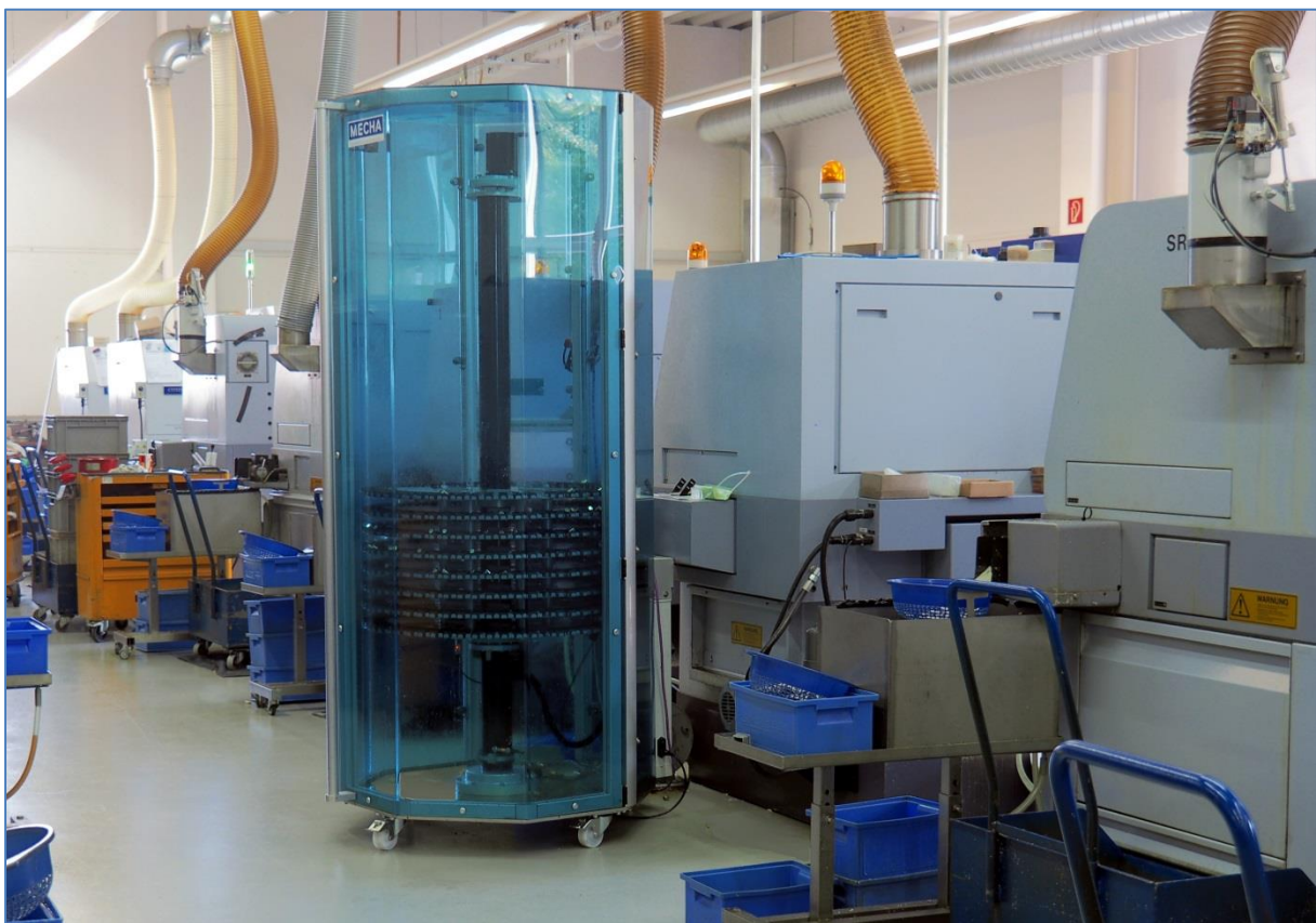
Abbildung 1: mit dem DepotMax in der Produktionshalle der Firma BB Zerspanungstechnik GmbH konnte der Ausschussanteil bei Glanzdrehteilen von 15% auf unter 2% reduziert werden.
