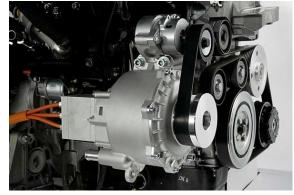
Kennzeichnend für den Corsa-Hybrid-Konzept ist ein riemengetriebener Starter-Generator der neuesten Generation.
