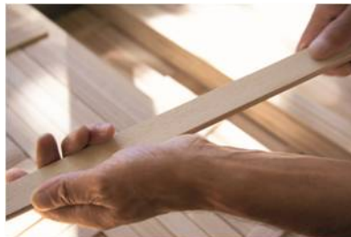
Lamellen aus unbehandeltem massivem Eschenholz bieten hohe Elastizität.
