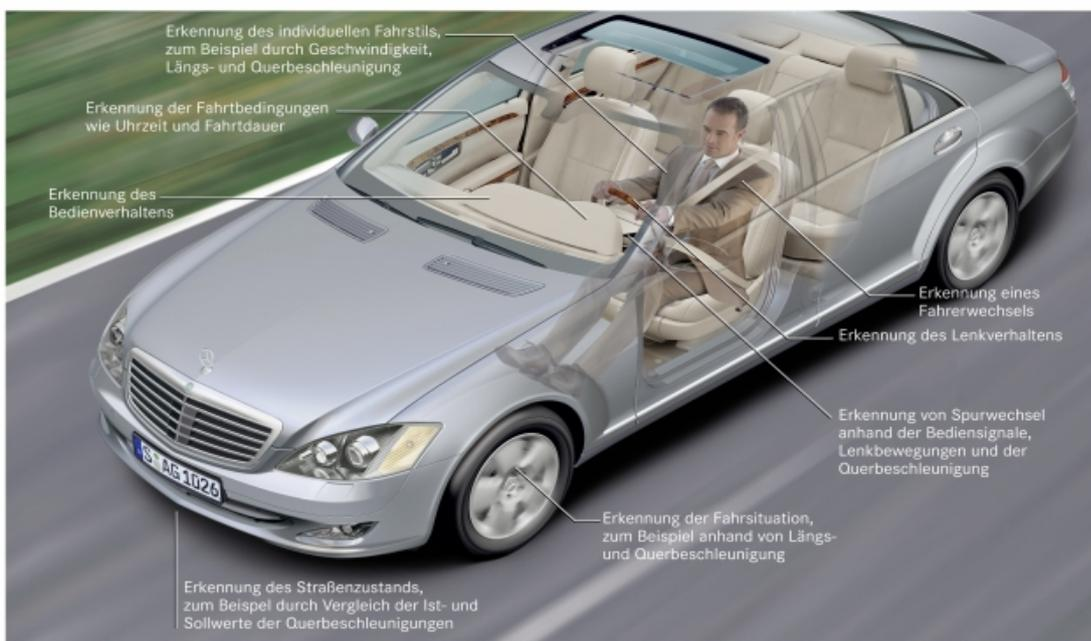
Das Kernstück des Mercedes-Systems ist ein hochempfindlicher Sensor, der eine sehr genaue Beobachtung der Lenkbewegungen und der Lenkgeschwindigkeit ermöglicht.
