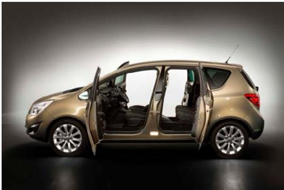
Der neue Opel Meriva: Eine ganz neue Dimension eröffnen die an der C-Säule angeschlagenen hinteren Türen. Die unabhängig voneinander öffnenden vollwertigen Türen, FlexDoors genannt, sind einmalig in der Fahrzeug-Großserienproduktion. Sie erleichtern den Ein- und Ausstieg für die Fondpassagiere ganz erheblich.
