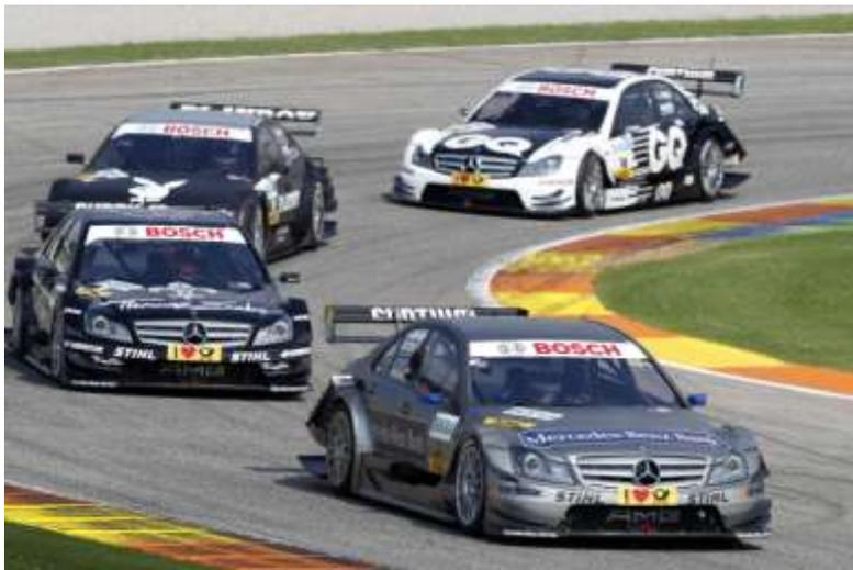
Bestplatziertes Mercedes-Pilot in der DTM 2011 war Bruno Spengler (auf dem Bild vorne). Er fuhr eine AMG Mercedes C-Klasse mit V8-Motor, 4000 ccm Hubraum, zirka 500 PS Leistung und einem Basisgewicht (inklusive Fahrer) von 1.050 Kilogramm. Das heckangetriebene Fahrzeug ist 4,87 Meter lang, 1,45 Meter breit und 1,25 Meter hoch.
