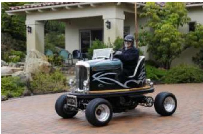
Das große Chamäleon unter den hippen Mini-Fahrzeugen: Das Grundkonstrukt basiert auf einem Lusse Auto-Scooter aus dem Jahr 1936, das mit einem Yamaha-750ccm-Motorrad-Motor aus dem Jahr 1997 und einem Sechsgang-Getriebe ausgestattet wurde. Weitere Kennzeichen sind eine komplette Holzverkleidung, ein verchromter Kühlergrill sowie eine kippbare Windschutzscheibe. Die Lackierung wechselt unter Sonnenlicht die Farbe – wie ein Chamäleon.
